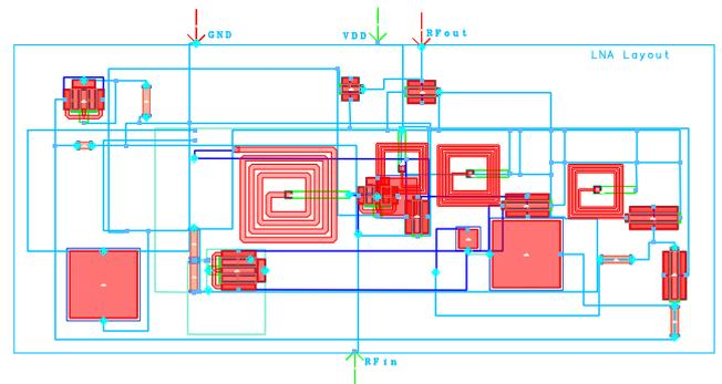
Fig. 6 Layout of wideband LNA
