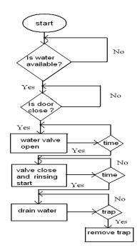
Fig. 3. Flowchart of rinsing module
